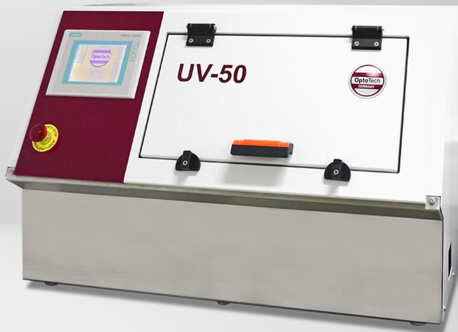
Qualitätstest der Beschichtung durch beschleunigte Alterung unter Behandlung mit Wärme, Feuchtigkeit und UV-Strahlung.
