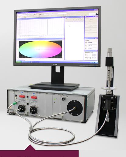
Das OptoTech Spektralfotometer ETA-ARC ist ein schnelles, präzises und einfach zu bedienendes Messsystem für dünne Filmbeschichtungen und Hartbeschichtungen.
