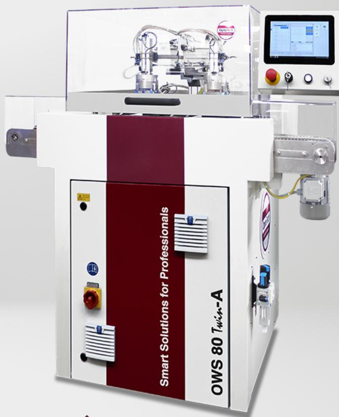
Die OWS 80 Twin-A wurde speziell für die automatische Reinigung und Trocknung von geblockten oder ungeblockten (Option) Brillengläsern auf einer sehr kleinen Stellfläche entwickelt. Diese Maschine ist mit 2 Reinigungs- und Trocknungsstationen ausgestattet, sodass die OWS 80 Twin-A mindestens 240 Gläser/h reinigen und trocknen kann.
