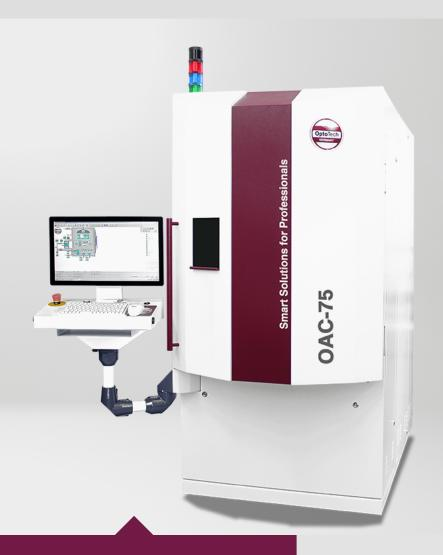
Die OptoTech Beschichtungsanlage OAC-75 wird zum Auftragen von hochwertigem Antireflex-Beschichtungen (AR) und sogenannten Clean Coats (CC) auf ophthalmischen Linsen verwendet. Das OAC-Beschichtungssystem zeichnet sich durch die für OptoTech bekannte Produktqualität, einfache Handhabung und Zuverlässigkeit im täglichen Produktionsbetrieb aus.
