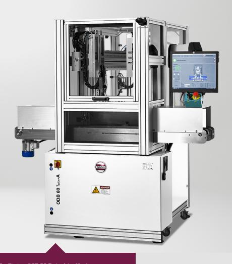
Der OptoTech Auto De-Blocker ODB 80 Twin-A ist für das professionelle, vollautomatische Abblocken konzipiert. Die Maschine ermöglicht ein unterbrechungfreies Abblocken ohne Wartezeiten.
